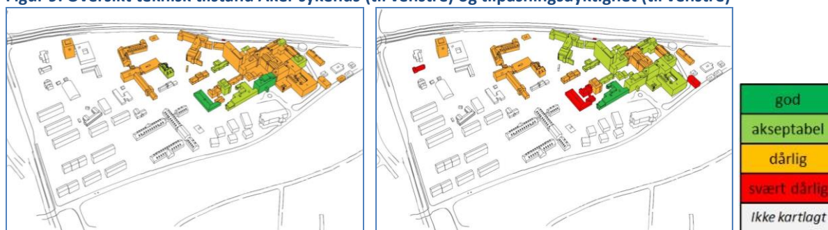
Figur 9: Oversikt teknisk tilstand Aker sykehus (til venstre) og tilpasningsdyktighet (til høyre)
