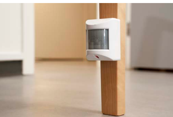
SENSOR: Sensor på sengebena registrerer bevegelse ut av sengen, og dimmer opp lyset i rommet.
